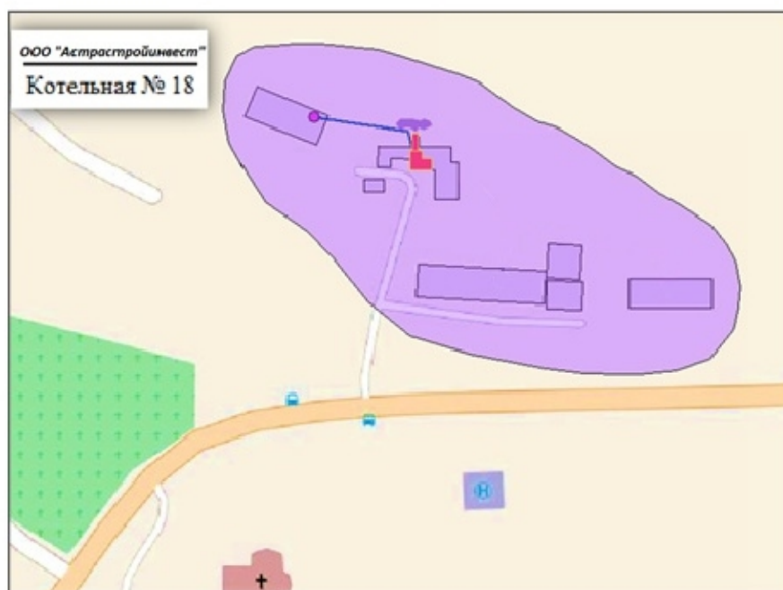
Рисунок 1.7 – Зона действия централизованного теплоснабжения котельной №18.
