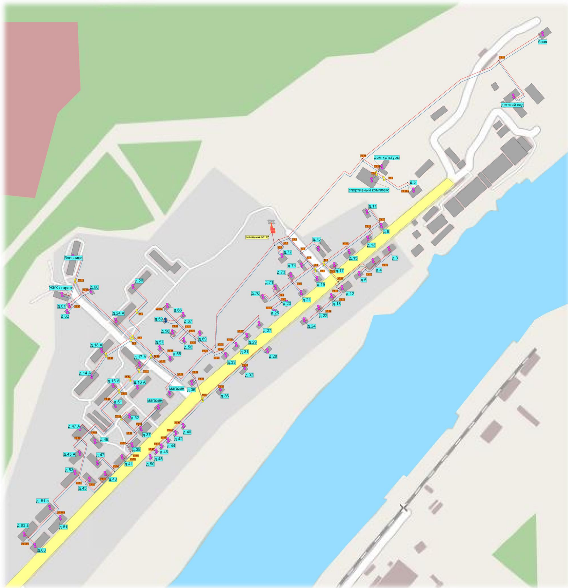
Рисунок 5.5.1. Схема тепловых сетей от котельной № 12 при переходе на 4-х трубную систему теплоснабжения.
