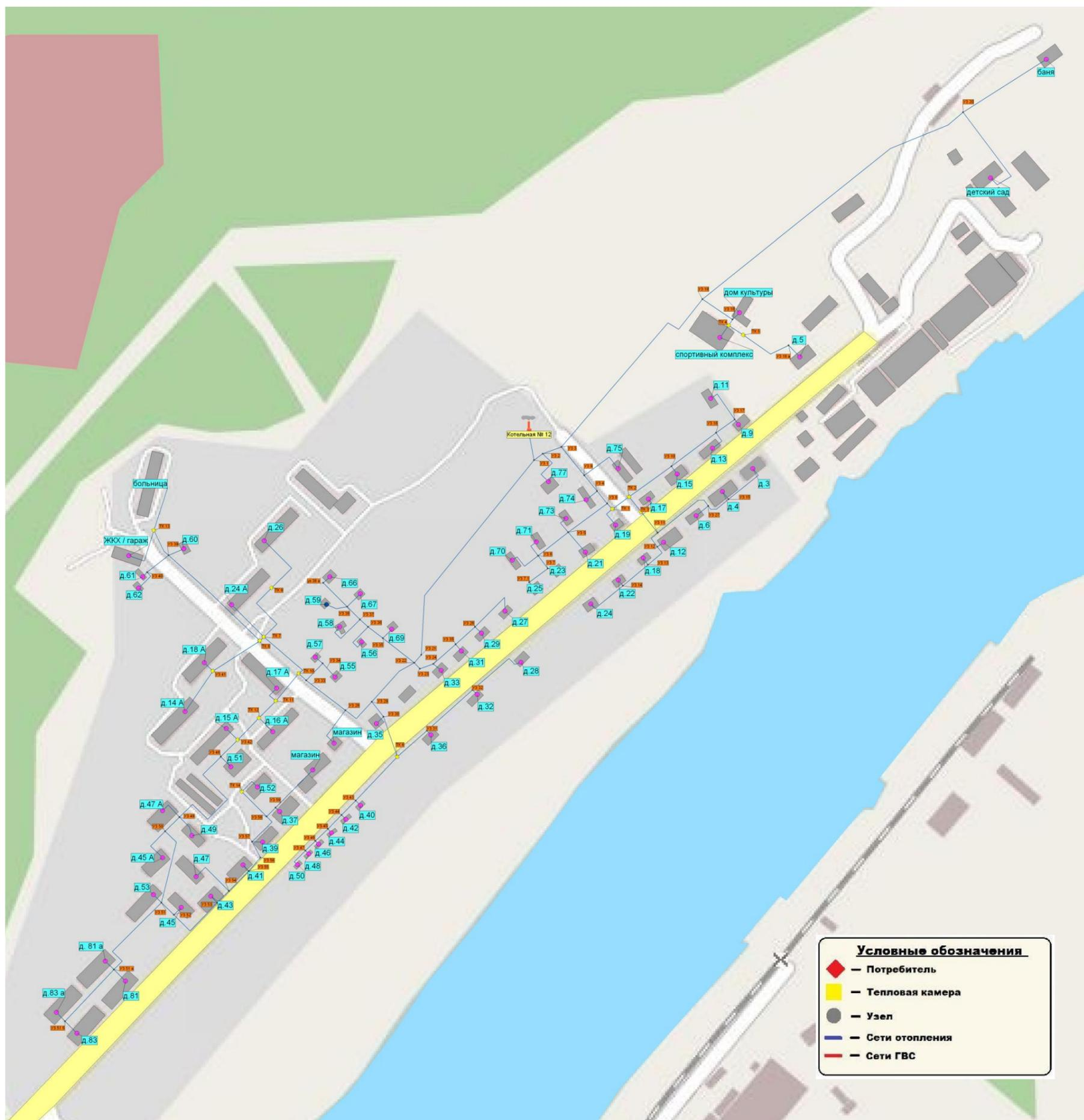
Рисунок 1.3.2.1. Схема тепловых сетей от котельной № 12.
