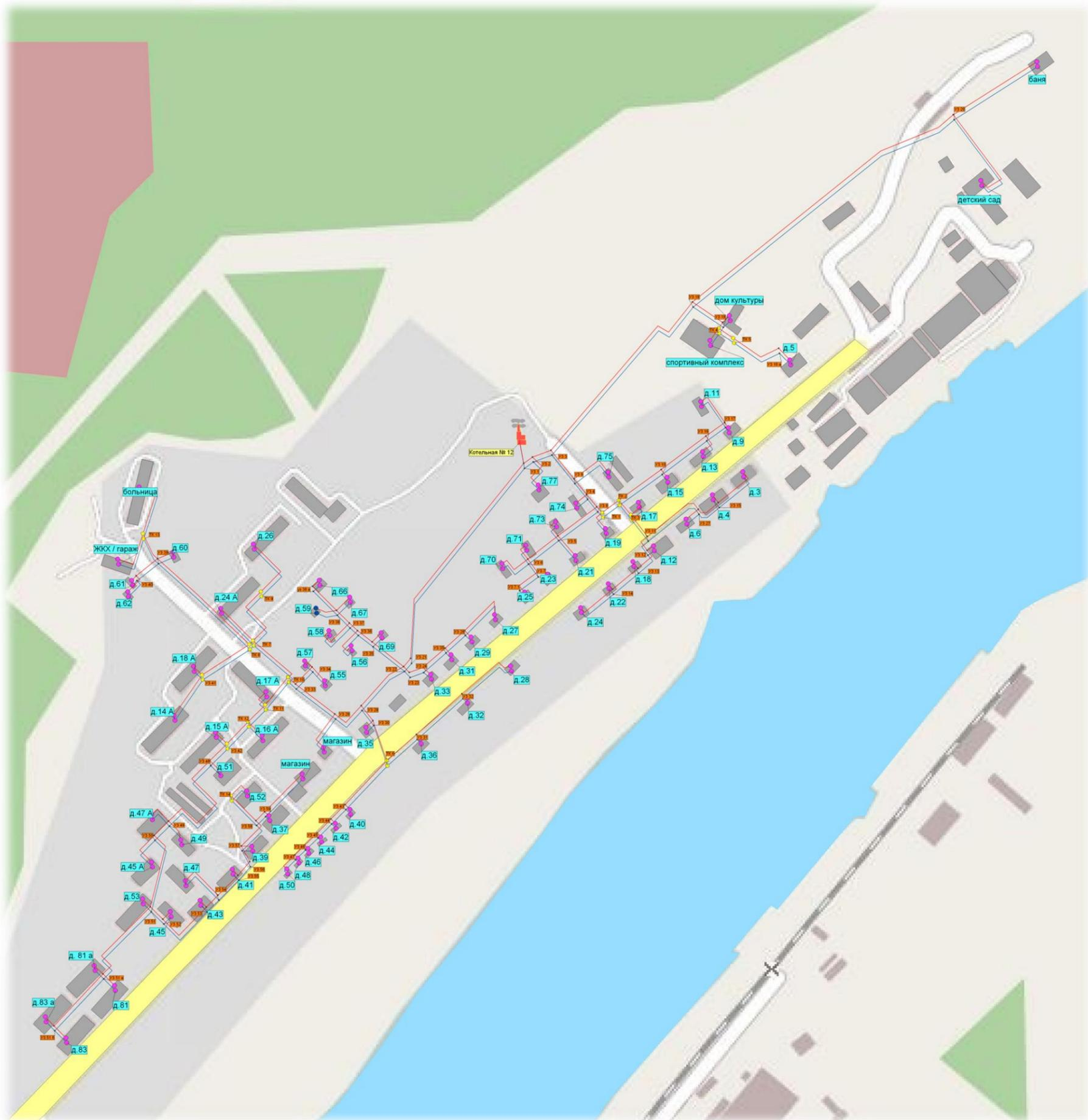
Рисунок 7.5.1. Схема тепловых сетей от котельной № 12 при переходе на 4-х трубную систему теплоснабжения.
