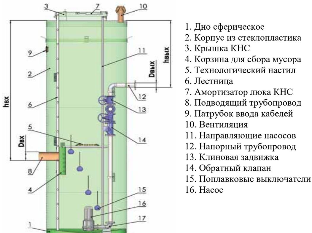
Рисунок 7.Схема КНС с погружными насосами.
